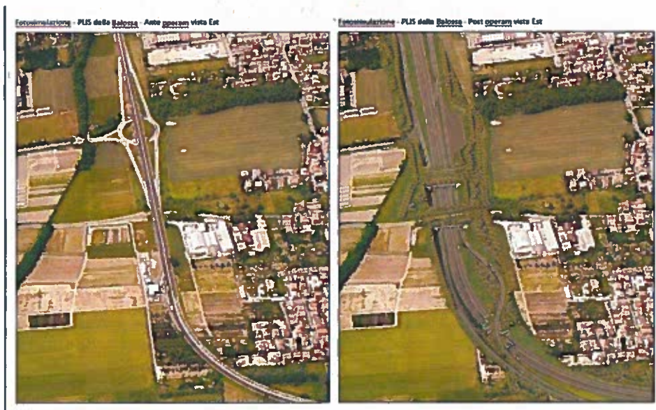
Figura 31: Fotoinserimento del nuovo tracciato della SP 46 Rho-Monza (fonte: Viabilità di adduzione al sistema autostradale esistente A8-A52 RHO-MONZA. Studio di impatto ambientale)
